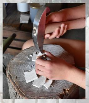
La martellina in ferro ha forma ad arco ed è predisposta per il taglio sulle estremità. Il tagliolo è un cuneo in ferro forgiato, infisso in un ceppo di legno atto a garantire solidità e stabilità durante le fasi di lavorazione.
