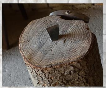
Il taglio del blocco di marmo è garantito se si mantiene una postura corretta, un allineamento della superficie tagliente della martellina con quella del tagliolo e un orientamento corretto del blocco tra i due strumenti.
